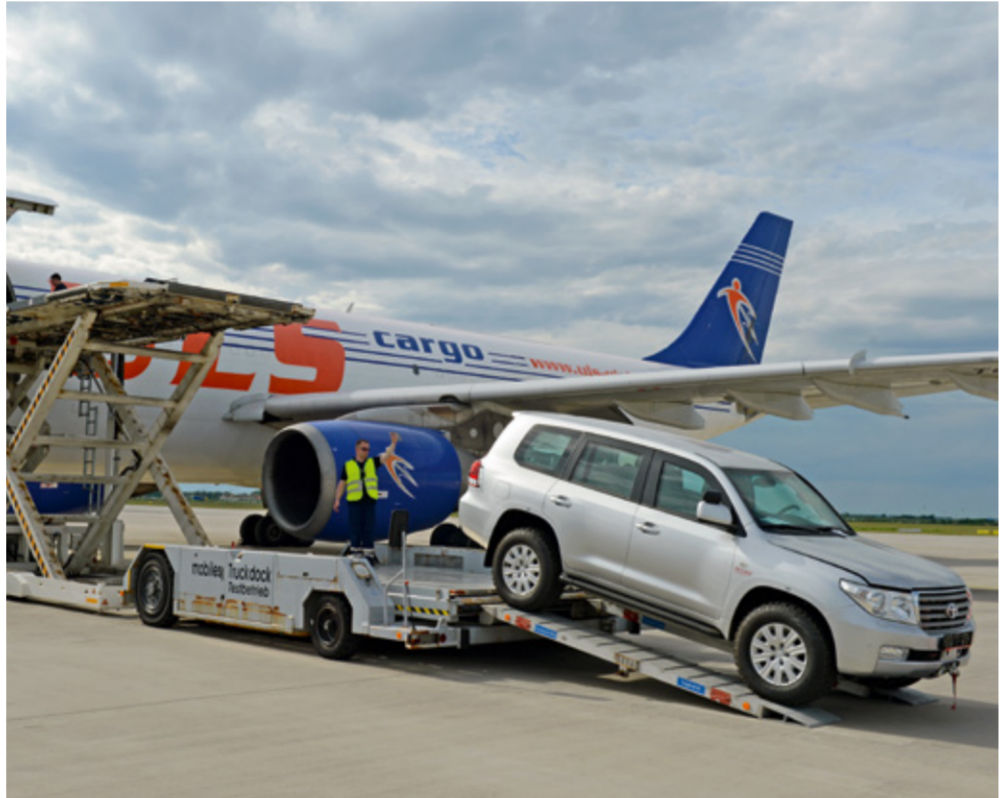
Verladung von Spezialfahrzeugen mit einem sogenannten „Highloader“
