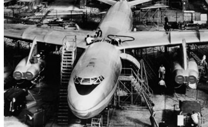
1960 - VEB Flugzeugwerk Dresden. Montage des Strahlverkehrsflugzeuges 152/II in der Halle 222
