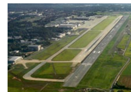
Sommer 2007 - Die neue, 2 850 Meter lange Start- und Landebahn (rechts) kurz vor der Eröffnung. Die alte Bahn (links) wurde abgerissen und begrünt.
